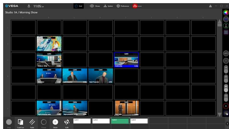
Vinten VEGAコントロールシステムは、階層的なプリセットを活用することで、カメラの自動制御に柔軟性をもたらします。これには、個別のショット（ポイント・トゥ・ポイント）、一連のカメラ動作を定義するシーケンス、複数のカメラを同時に所定の位置へ移動させるマルチショット（複数のショットをまとめた“コンテナ”）などが含まれます。
