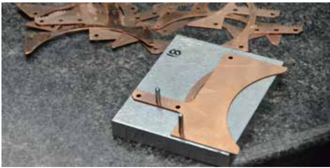
7. 一組の銅板を、間にスペーサを挟みながら治具上に重ねて積んでいく。
