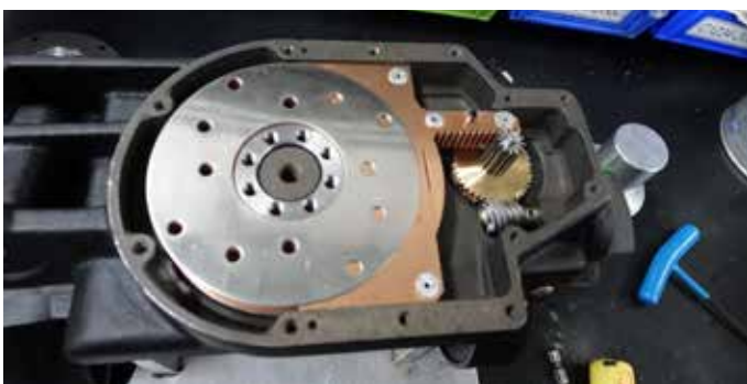
10. ドラッグアセンブリーを、ベースとなる鋳物パーツに取付ける。
