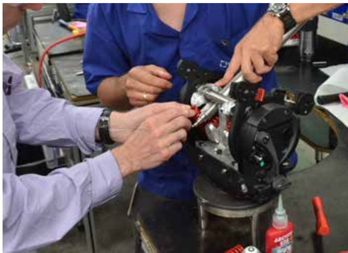
15. スプリングを内部に取り付ける。これは最も難しい作業だ。
