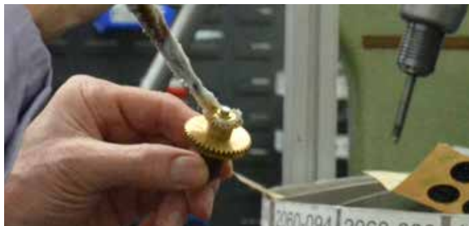
2. パンドラッグ調整部のリングにグリスを塗る。
