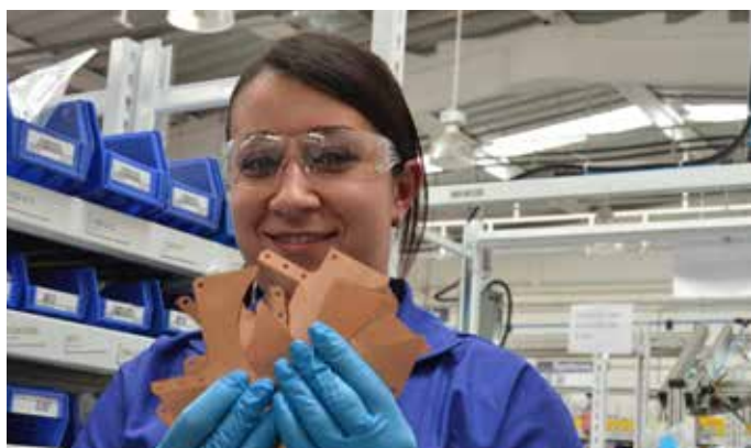
4. ここから作業は難しくなっていく。Katherine Montoyaが持っているのは2575Dヘッドのドラッグ抗力を生み出す銅板である。
