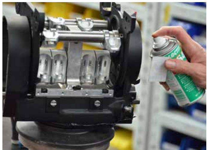
14. ウィップルツリーアセンブリーに取り付ける部品を用意し、グリスを塗る。
