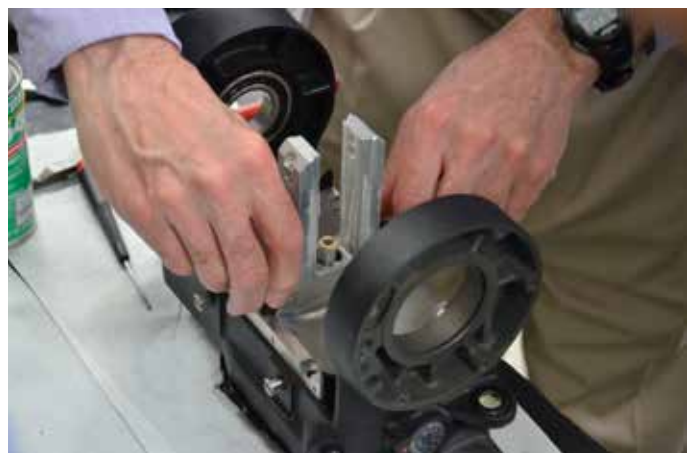
13. カウンターバランスハウジングを取付ける。
