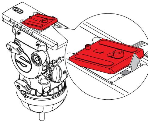
5. カメラの重心付近にカメラプレートを装着します。 .
