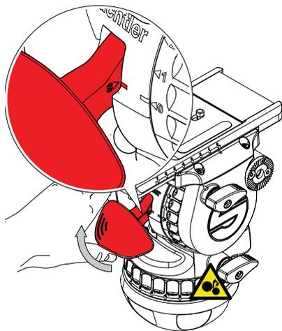
6. ノブの外輪を押し上げ、徐々に時計回りに回しながら、隙間ができないようにボウルコネクターを指で締めてください。
