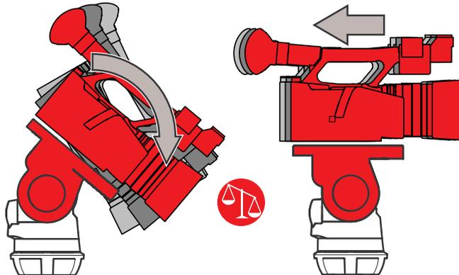
(d) 積載物の動きを再度確認します。さらに調整が必要な場合は、1 から 3 までの手順を繰り返します。
