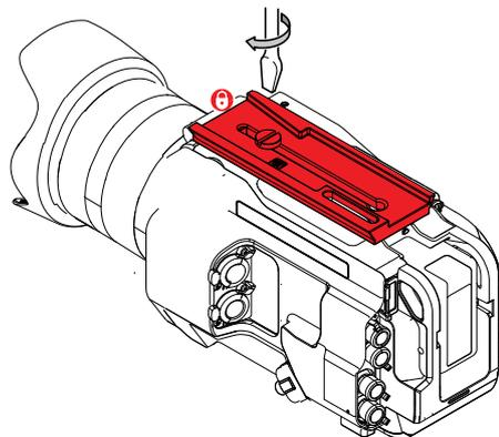
5. カメラプレートを下図の要領で、スライディングバランスプレートの溝に配置し、はめ込みます。
