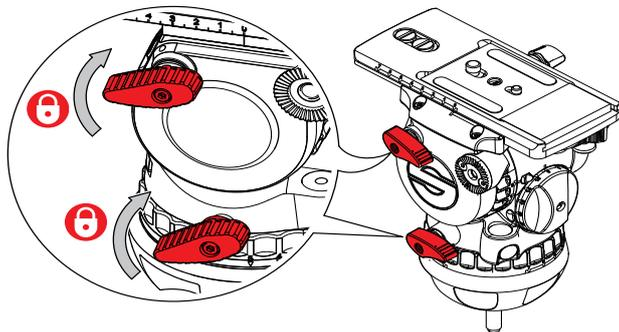
2. 一方の手でカメラプレートまたはカメラを押さえます。親指と人差し指でクイックリリースレバーを握り、安全ロックを引き下げます。
