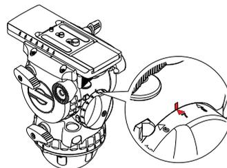
2. 積載物を両方向に約 30°チルトして放します。離れたときに積載物が同じ位置に留まる場合は正しくバランスが取れています。
