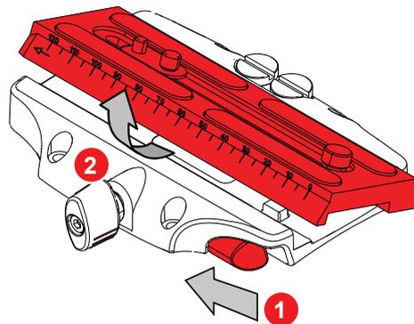
4. カメラプレートカメラの重心付近に取り付け、プレートの矢印の方向を確認します。追加のネジはスライディングバランスプレートアセンブリに保管されています。
