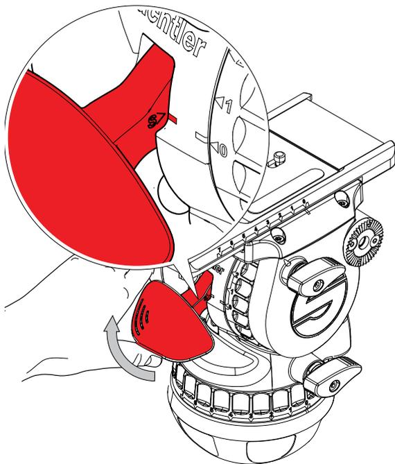
2. 上から、または正面からプリズム水準器を確認しながら、ヘッドを動かして水平位置に調整してください。(暗い場所では照明を操作して見やすくしてください。)
