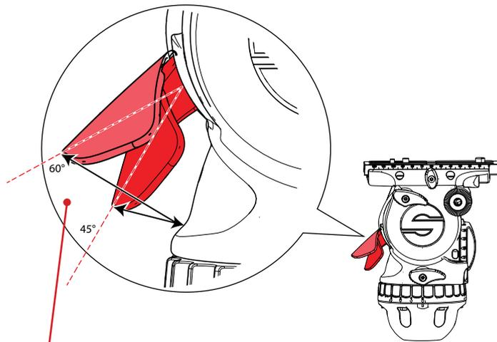
正しく調整できている場合、レバーを下げるとヘッドから約 45° ~ 60° (30mm ~ 50mm) の間に収まります。
