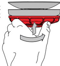
7. 下図のように、スピードレベルレバーがヘッド本体から約 45° から 60° (30mm から 50mm) の間にあれば正しく調整できています。レバーが下図よりもヘッド側になってしまう場合は、ボウルコネクターが緩すぎるため、手順 5 と 6 を繰り返して調節してください。
