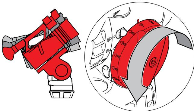
5. 積載物をプラスおよびマイナスの移動角度に傾け、希望しているチルト角に留まることを確認します。
