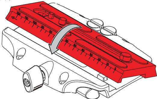
6. クランプノブを使用してバランス調整を行ったうえで、その位置でプレートをしっかりとロックします。
