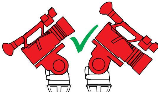
3. 放したときに積載物が上方に動き続ける場合は、バランスが強すぎる位置にセットされています。調節ノブの設定を1段階ずつ下げてテストし直します。
