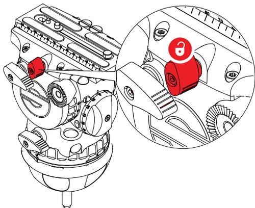
3. サイドロード安全ロック (1) を押してプレート (2) を外します。
