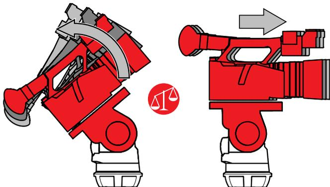
(c) 積載物が前方に傾く場合は、ヘッドの後方に積載物をスライドし、カメラプレート（バランスプレート）を再度ロックします。
