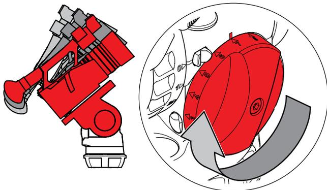
4. 放したときに積載物が下方に動き続ける場合は、バランスが弱すぎる位置にセットされています。調節ノブの設定を1段階ずつ上げてテストし直します。
